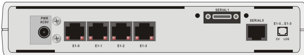
Рис. 10. Задняя панель мультиплексора ГМ-1-Л4У
