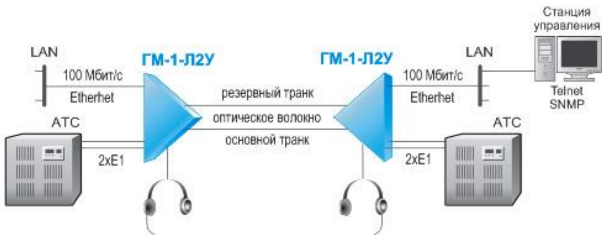
Рис. 2. Вариант применения мультиплексора ГМ-1-Л2У
