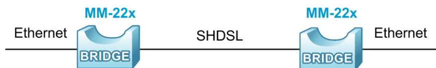
Рис. 20 Пример схемы передачи Ethernet через канал SHDSL
