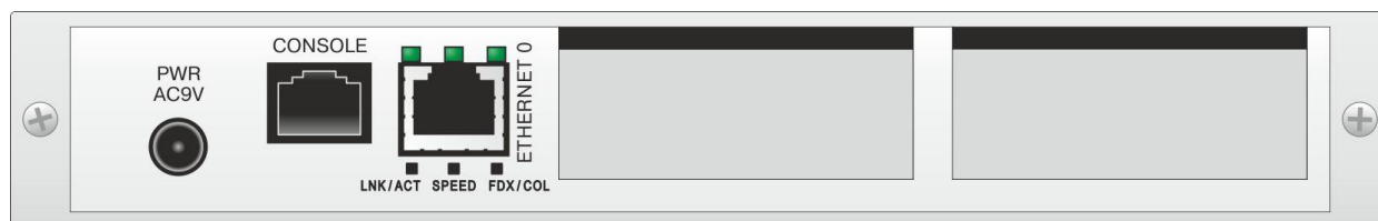
Рис. 26 — Вид задней панели изделий MM-221RC-UNI-I-AC9 и MM-222RC-UNI-I-AC9 для установки в конструктивы P-12 и P-510 с питанием от сети переменного тока
