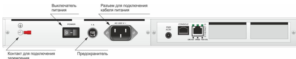
Рис. 28 — Вид задней панели изделий MM-221RC-UNI и MM-222RC-UNI в металлическом корпусе 19"
