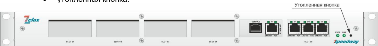
Рис. 22 — Вид передней панели изделий MM-525RC-UNI
