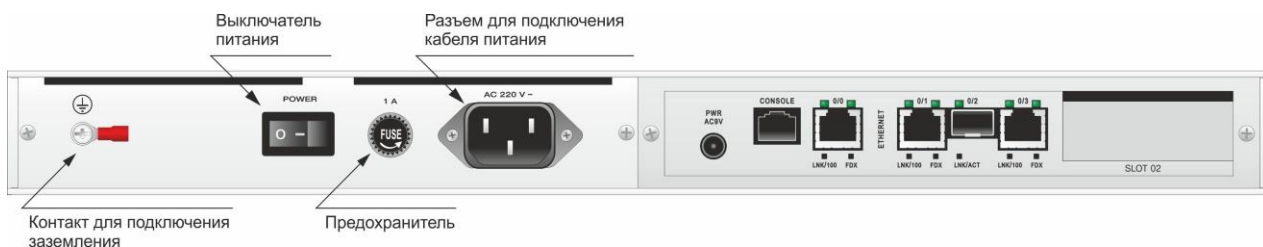
Рис. 38 — Вид задней панели изделий MM-227RC-UNI в металлическом корпусе 19"
