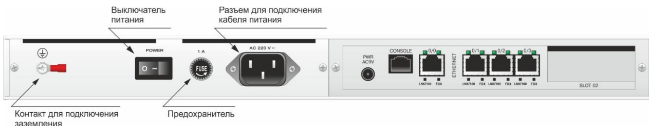
Рис. 37 — Вид задней панели изделий MM-225RC-UNI в металлическом корпусе 19"
